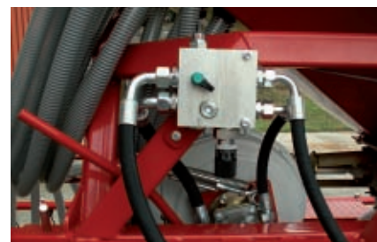
Antrenarea hidraulică a ventilatorului (dotare opțională) îmbunătățește confortul în exploatare, manevrabilitatea și durata de exploatare a ventilatorului.
