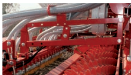
Antrenarea hidraulică a ventilatorului (dotare opțională) îmbunătățește confortul în exploatare, manevrabilitatea și durata de exploatare a ventilatorului.
